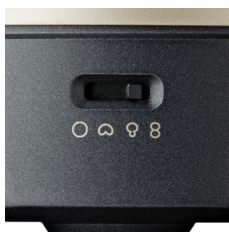
Figura 1: Conmutador-selector para las características direccionales
