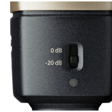
Abbildung 2: Wahlschalter für Vorabschwächung
