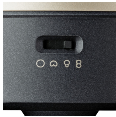
Abbildung 1: Wahlschalter für Richtcharakteristiken
